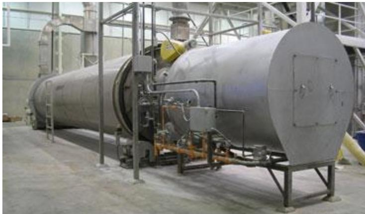
Figura 7.6: Fotografía secador rotativo de granos
